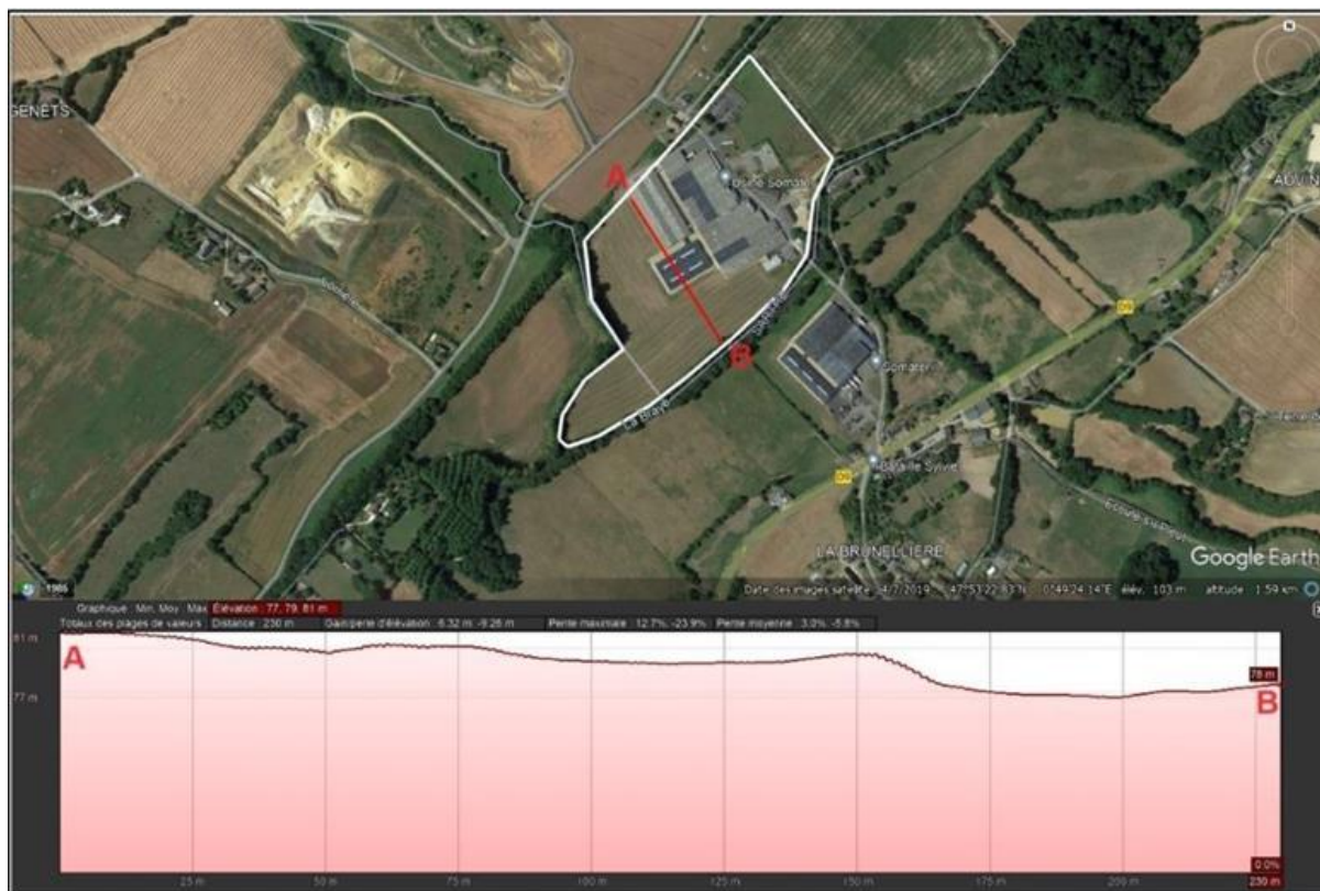
Figure 29 : Profil altimétrique Nord-Sud du site
