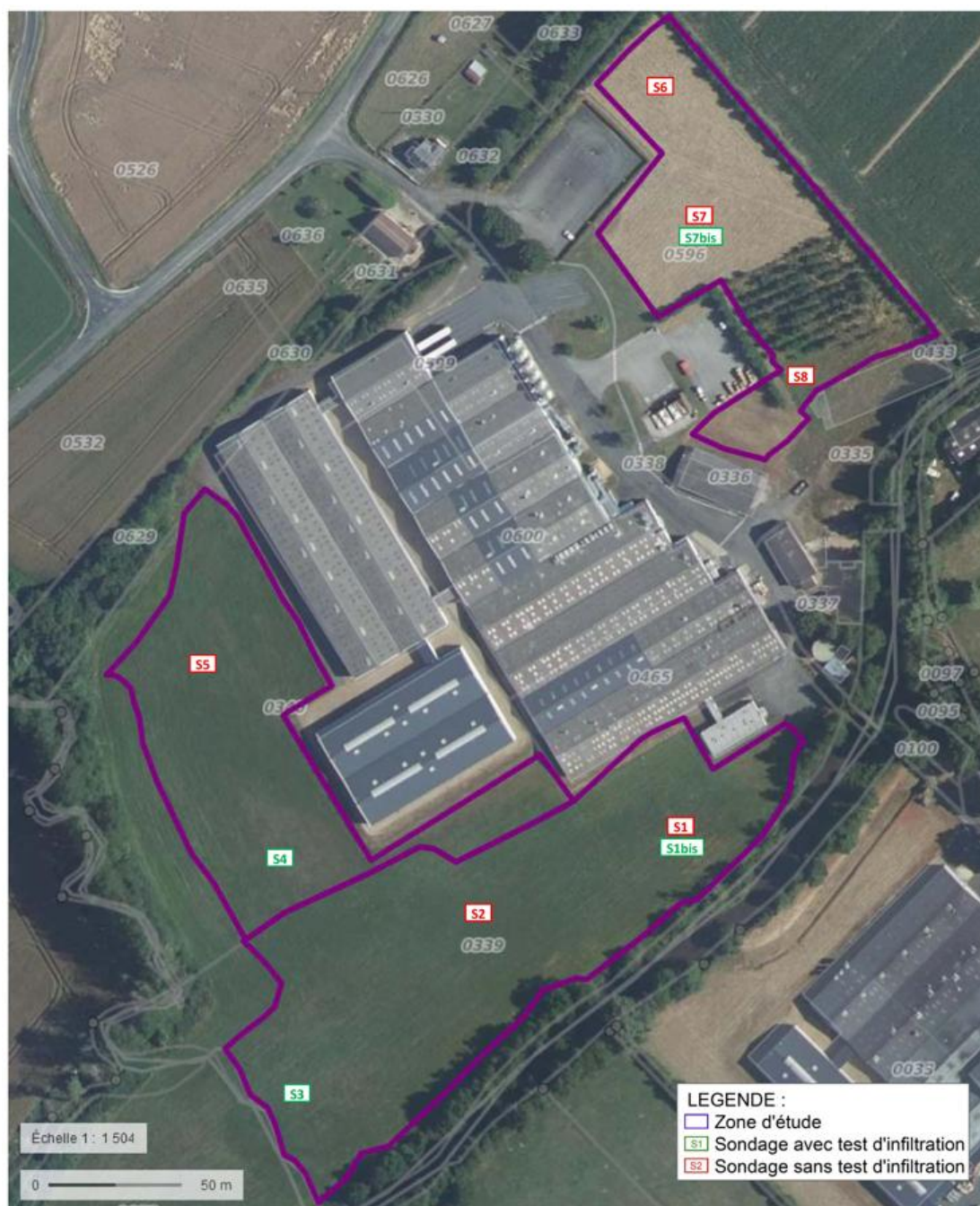
Figure 24: Localisation des sondages réalisés (source : SOND&EAU)
